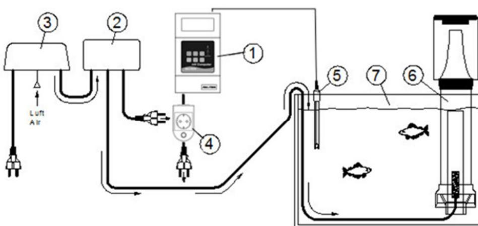
**Schéma 2 : Example d'installation du mV-Contrôle et régulation de l'aquarium avec un Ozoniseur**
