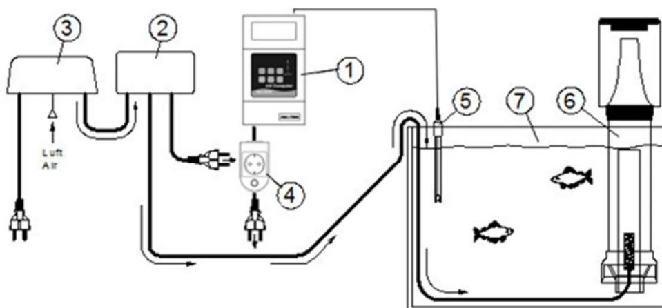
**Fig. 2: Voorbeeld installatie - mV-meting en wijzigingen met ozonreactor**
